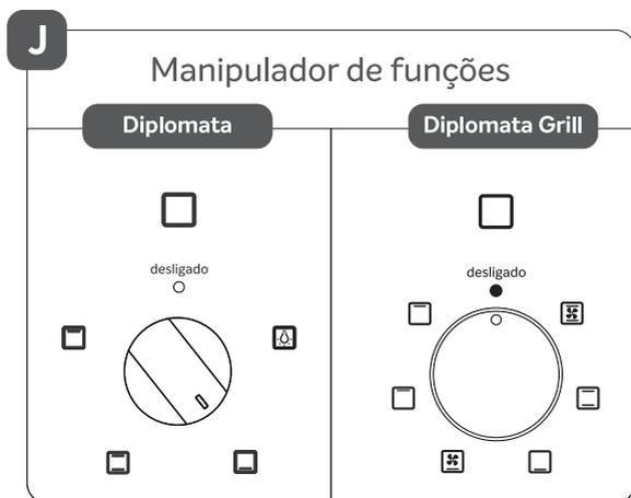
Para selecionar a função, posicione o manipulador de funções (Fig. J) na posição desejada, conforme os ícones a seguir:
